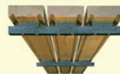
deska bangkirai , gładka 8,8 x 1,8 cm / polietylenowe. podkładki 1,3 cm + polietylen. legary montażowe deck-u 3,0 cm / deck poziomy / podłoże – kostka brukowa
